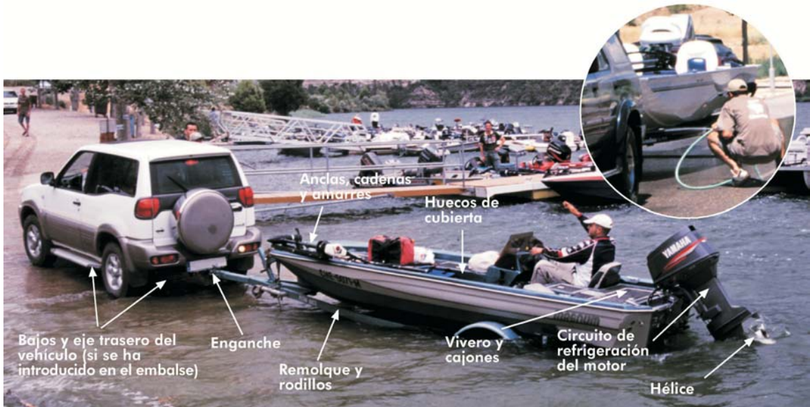
Puntos más vulnerables en los que se pueden adherir las larvas de mejillón cebra.
